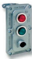
Pulsante doppio/Double push button II 2 GD Ex d IIB T5/T6 Ex tD A21 IP66
